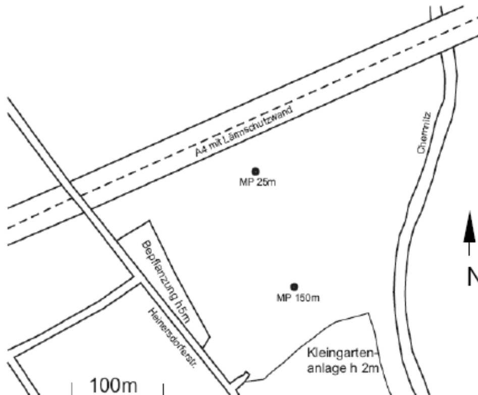
Abb. 2: Messgebiet bei Schallschutzbauten an der Autobahn A4 nahe Chemnitz. Die Messpunkte (MP) sind 25 m bzw. 150 m von der Autobahn entfernt.
