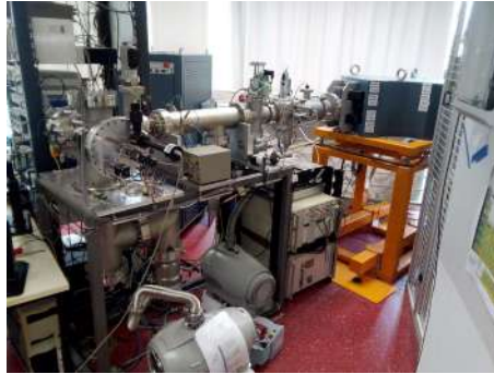
Figure 14: 100 keV ion implanter of the Universität Leipzig
