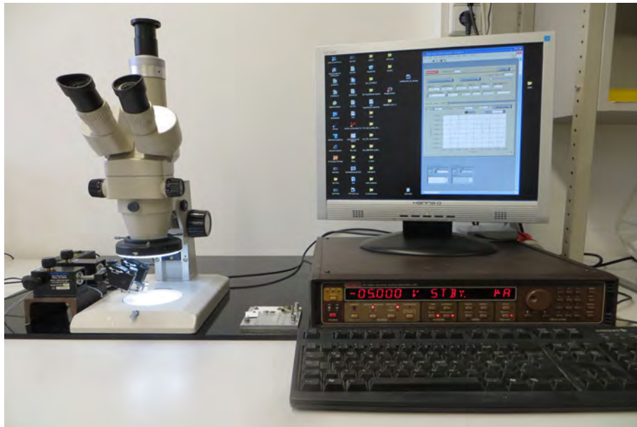
Abbildung 2.2.1: Aufnahme des Spitzenmessplatzes. Die Messspitzen (links im Bild) können mit dem Stereo-Mikroskop mikrometergenau auf der Probe platziert werden. Mit einem Messprogramm am PC können so Strom-Spannungs-Kennlinien aufgezeichnet werden.
