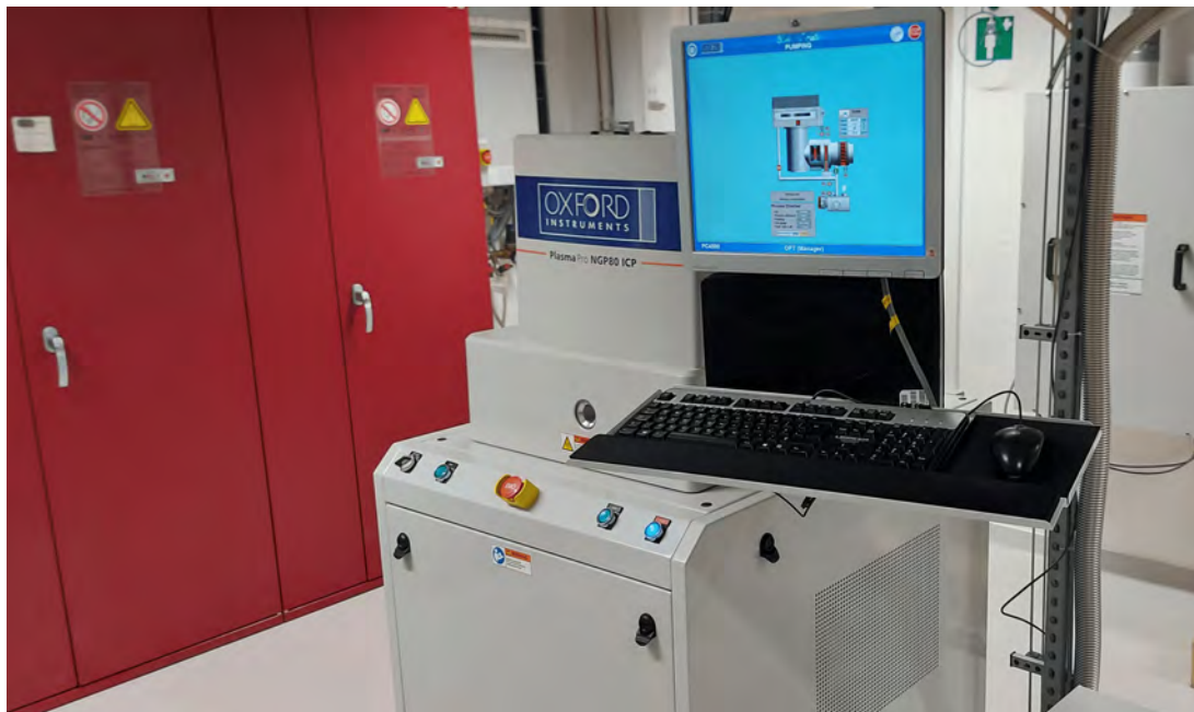
Abbildung 13: Probenkammer mit angeschlossener Computertechnik zur Steuerung und Überwachung aller Systemrelevanten Informationen für das Plasma Ätzverfahren.
