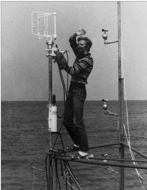
Abb. 20: Arbeit an einem akustischen Anemometer des Moskauer Akademie-Instituts für Ozeanologie, am Mast G. N. Panin (Foto: Archiv Hupfer).
