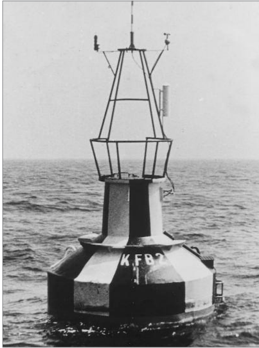
Abb. 18: Die meteorologische Küstenfunkboje KFB-2 (Foto: H. Bürkholz)
