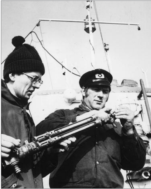
Abb. 8: Übungen mit Wasserschöpfer und Umkippthermometern (Foto: F. Fischer).
