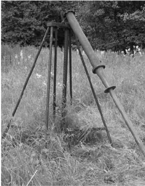
Abbildung 1: Links: Schallquelle, ein Signal wurde alle 60 s ausgesandt. Rechts: Messmikrophon des LIM-Messsystems.
