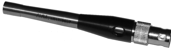
Abbildung 44: Kondensatormessmikrofon (1/4 Zoll) vom Typ "MI 17" der Firma AVM.
