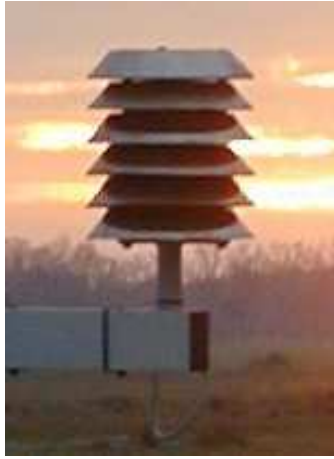
Abb. 1: Linke Seite: Natürlich ventilierte Strahlungsschutzhütte für Temperaturmessungen nach R.M. Young (Foto: A. Grüner, 2004). Rechte Seite: Elektromechanisch ventilierter Temperatur- und Feuchtesensor HUMITTER 50 Y in doppelwandigem Strahlungsschutzrohr (Foto: M. Barth, 2004).
