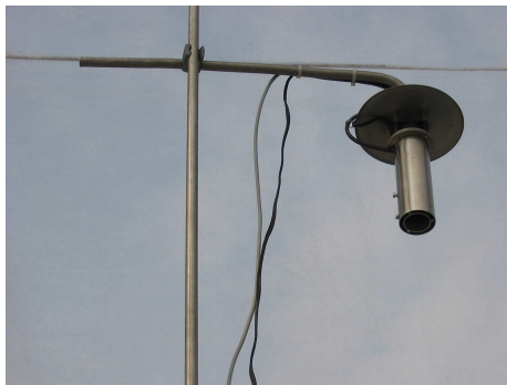
Abbildung 1: Profilmast mit ventilierten Humitter 50Y Fühlern in Strahlungsschutzhütten, montiert in 2 Höhen (links: 3,32 m, rechts: 0,44 m).
