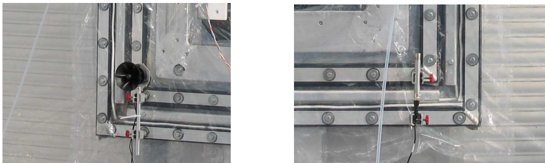
Abbildung 3: Lautsprecher (links) und Mikrofon (rechts) zur Bestimmung der Schallgeschwindigkeit in SAPHIR auf möglichst langem Ausbreitungsweg. An den Stirnseiten der Kammer wurde jeweils ein Mikrofon und ein Lautsprecher mit Magnethalterungen befestigt. Die Schallweglänge betrug ca. 18,3 m.
