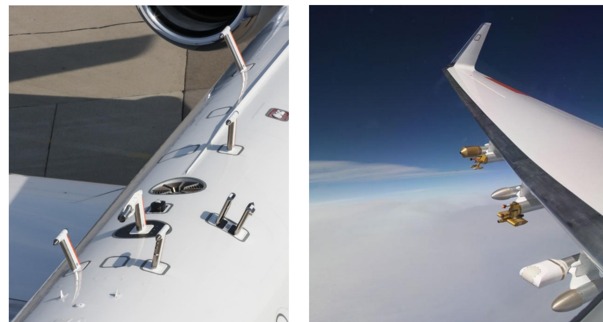
In-situ Messungen. Links: Lufteinlässe, rechts: PMS Sonden; Fotos: DLR, Minikin
